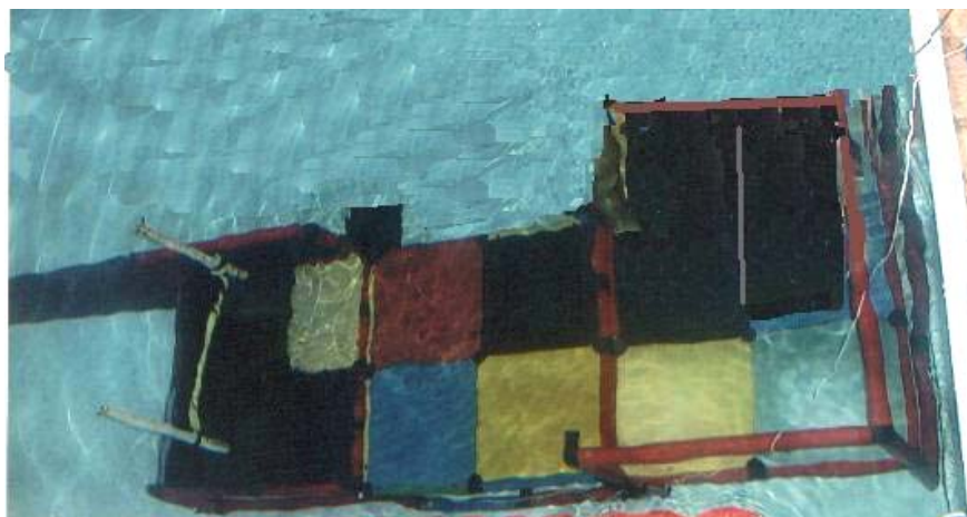
Figura 4: redutor de profundidade posicionado no fundo da piscina
