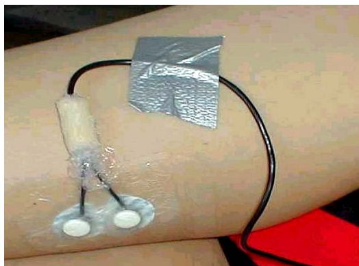
Figura 3: eletrodos com silicone e adesivos oclusivos
