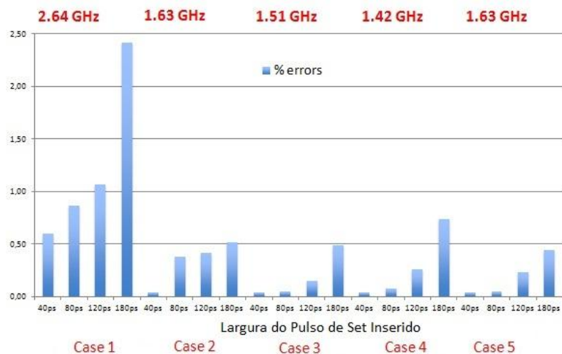
Figura 5.6: Percentual de erro com relação à largura do pulso de SET para o circuito 432.
