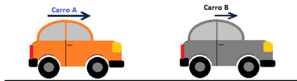
Figura 4: Colisão traseira, onde o carro A possui velocidade maior em módulo do que o carro B. Ambos na mesma direção e sentido.
