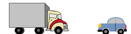
Figura 7: colisão frontal entre um caminhão e um carro, ambos com velocidades iguais em módulo, deslocando-se na mesma direção e sentidos opostos.
