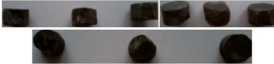
Figura 46: Ferramentas de cermet quebradas após o ensaio de usinabilidade
