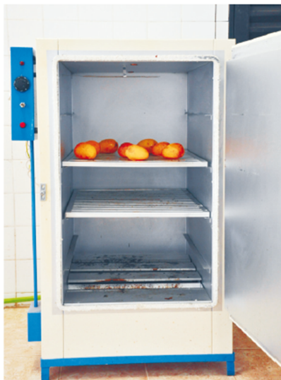
Figura 5: Secador com ar quente. Fonte: Celestina, 2010.
