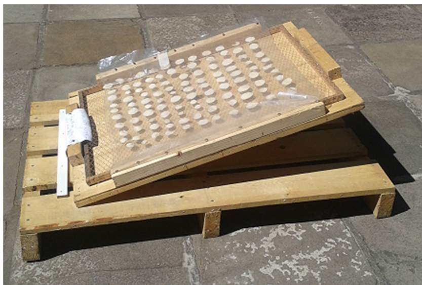
Figura 9: Secador solar montado para secagem de batata-doce.
