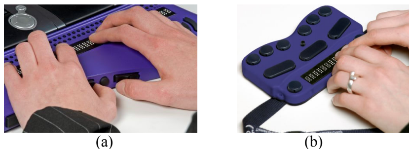
Figura 2.6. Linhas Braille. (a) ALVA Satellite Braille Display; (b) Easylink; Fonte: Optelec, 2013.
