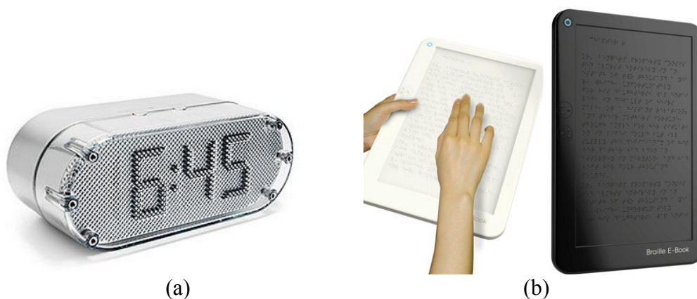
Figura 2.10. (a) Relógio que projeta horas pela utilização de solenoides (Fonte: NDigit, 2012); (b) Aparelho para leitura Braille de livros eletrônicos (Fonte: Yanko Design, 2012).
