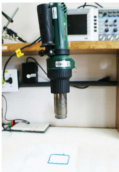
Figura 3.4. Soprador de ar fixado para teste de tempo de expansão da tinta.
