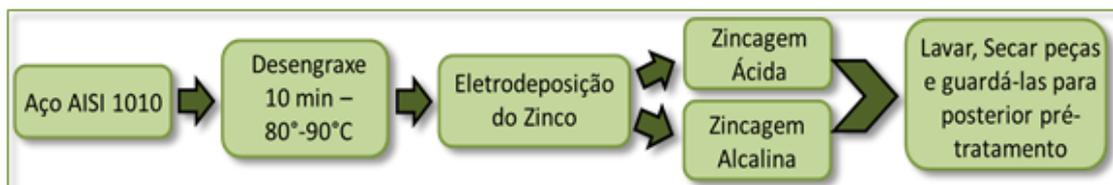
Figura 20. Fluxograma simplificado das etapas de obtenção do aço zincado por eletrodeposição.
