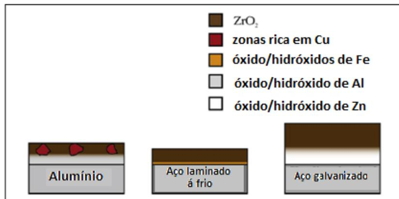
Figura 9. Deposição de zircônio sobre diferentes substratos [46].
