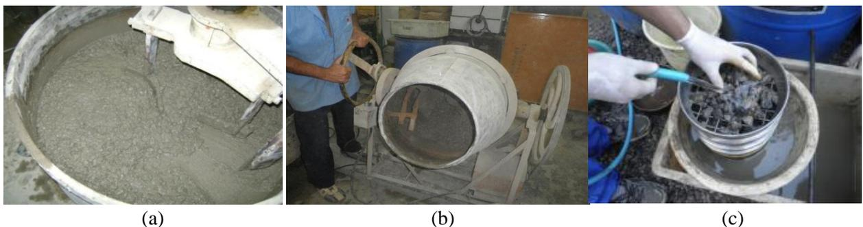
Figura 37: Produção dos concretos com AGRC: (a) Preparo em betoneira de eixo vertical, (b) Preparo em betoneira de eixo inclinado e (c) Lavagem dos concretos
