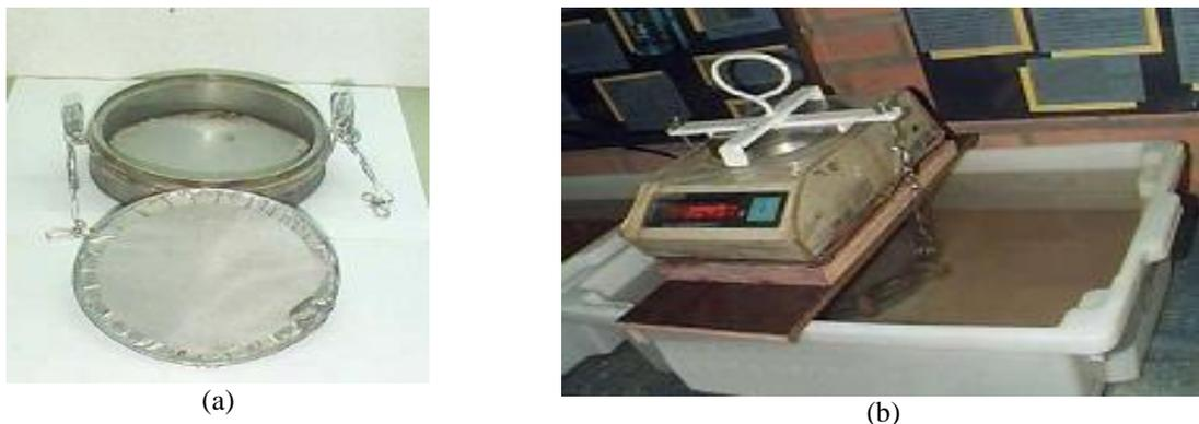
Figura 24: Ensaio de absorção do agregado reciclado: a) Recipiente utilizado para execução do ensaio de absorção; b) Amostra de agregado submersa (Fonte: LEITE, 2001).
