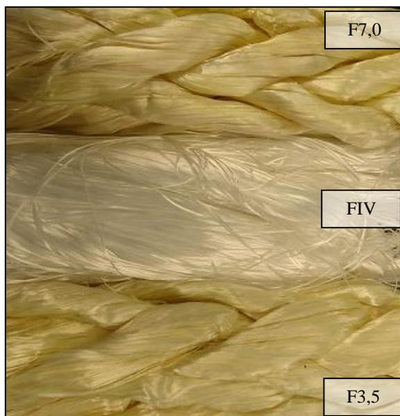
Para quantificar a variação de cor, brilho e opacidade observada nas amostras, foram realizadas análises colorimétricas e óticas, através de um espectrofotômetro. Os resultados obtidos são apresentados na Tabela 4.11.
