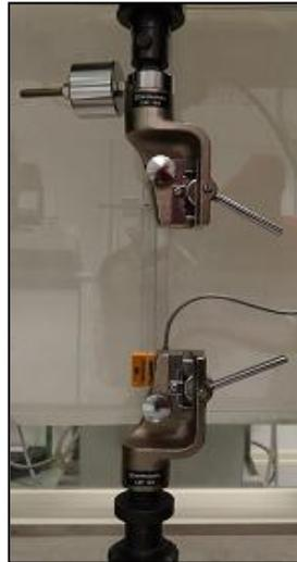
Para determinar o valor do módulo inicial foi utilizado o procedimento descrito na norma técnica ASTM D 885 [68]. Para cada cordão ensaiado, avaliou-se a curva de força *versus* alongamento (apresentada nos anexos), onde determinou-se a força necessária para produzir um alongamento de 10%. Determinada a força, utilizou-se a equação (3-4) para o cálculo do módulo inicial.
