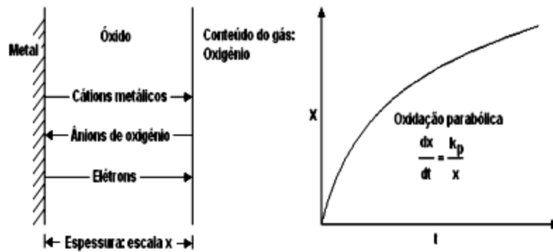
Figura 20. Representação esquemática do crescimento do filme de óxido de cromo [56].
