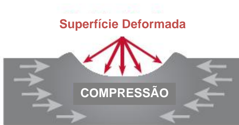
Figura 4. Deformação plástica formada no ponto de impacto de uma esfera no processo de shot peening [adaptado de 20].
