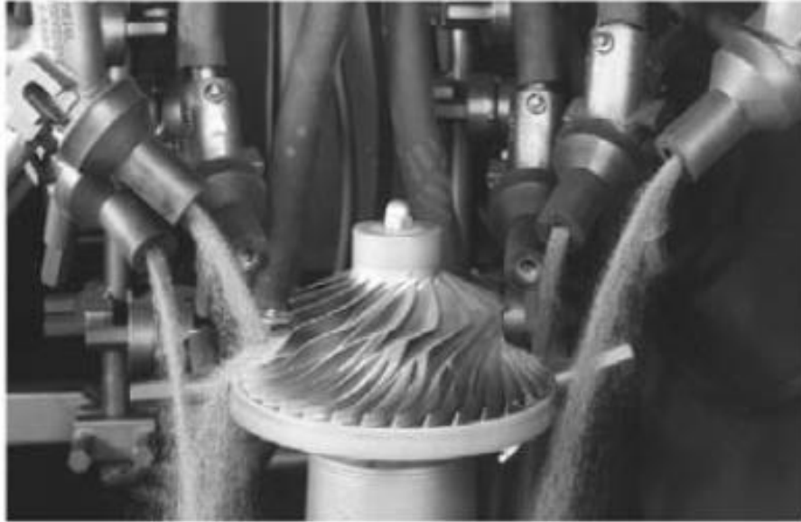
Figura 2. Processo de aplicação de shot peening [28].
