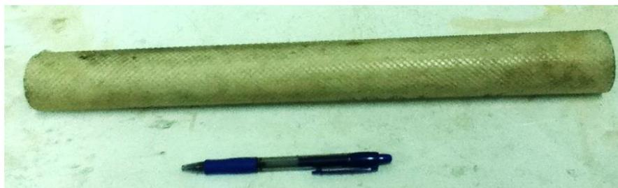
**Figura 3.1** Fotografia da membrana espiral de UF.
