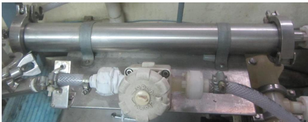
**Figura 3.6** Fotografia da carcaça do módulo de membrana espiral.
