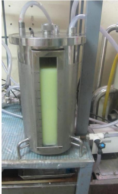
**Figura 3.3** Fotografia do tanque de alimentação com o banho termostático acoplado.
