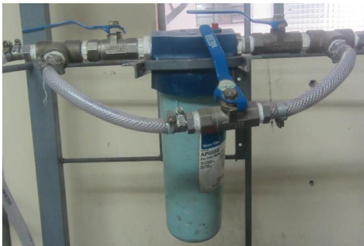
**Figura 3.5** Fotografia do pré-filtro de cartucho.
