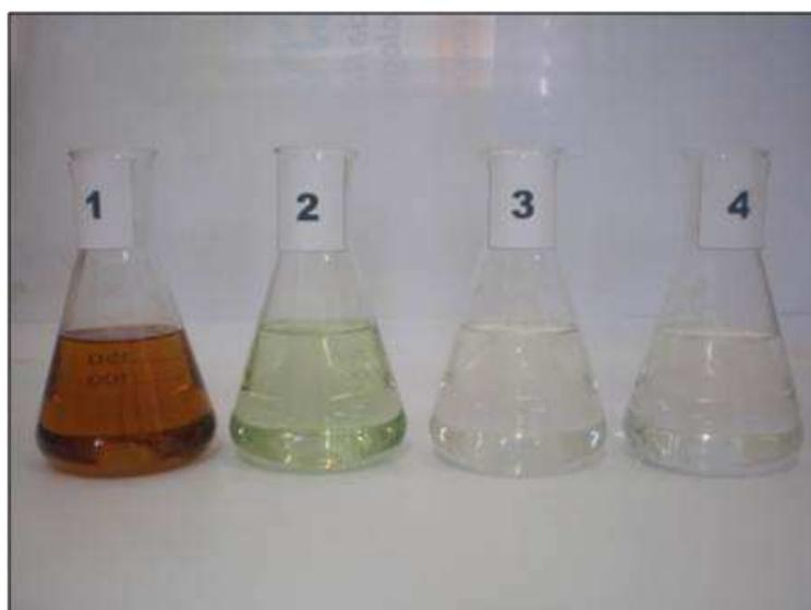
Figura 21 – Aspecto visual das amostras representativas dos efluentes nos quatro lisímetros.
