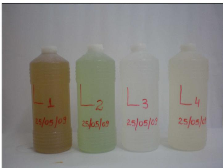
Figura 15 – Amostras representativas dos efluentes dos lisímetros.
