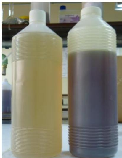
Figura 71. Concentrado férrico obtido após nove semanas de biolixiviação. À esquerda o sulfato férrico da coluna controle e à direita o mesmo reagente da coluna com nutriente sintético.
