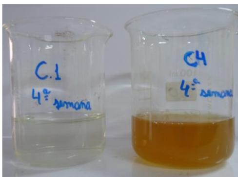
Figura 66. Lixívia obtida na quarta semana de biolixiviação em colunas. Na esquerda, a lixívia da coluna controle e à direita a lixívia da coluna com bactérias e nutrientes sintéticos.
