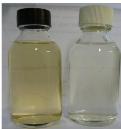
Figura 99. Água bruta e tratada com o coagulante produzido a partir do rejeito de carvão.
