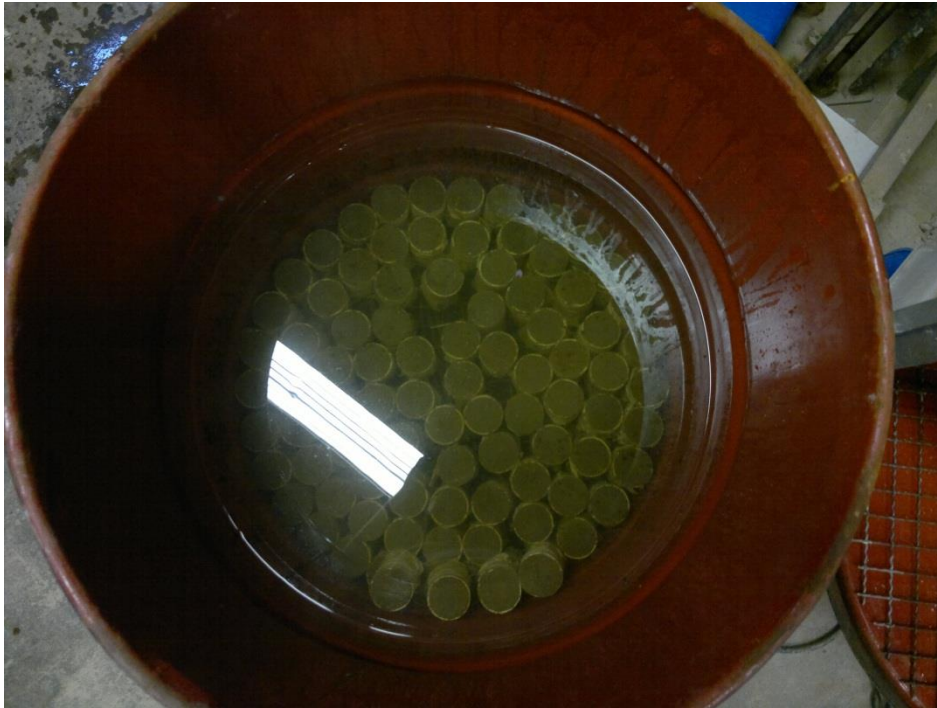
Figura 5.14: cura dos corpos de prova com temperatura controlada. (Elaborada pelo autor)
