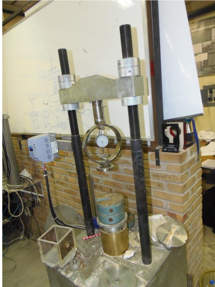
Figura 5.16: prensa utilizada nos ensaios de ruptura. (Elaborada pelo autor)
