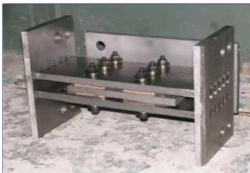
Figura 2.2 - Dispositivo Slotted Bolted Connection SBC. Fonte: (Chopra, 2002)
