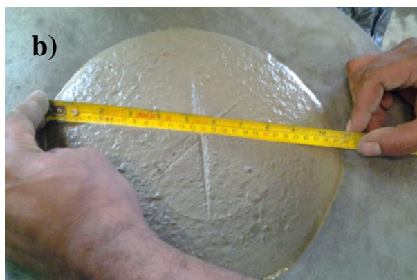
Figura 5 – Consistência da argamassa a) traço 1 – 2ª medida = 260 mm b) traço 3 – 3ª medida = 270 mm
