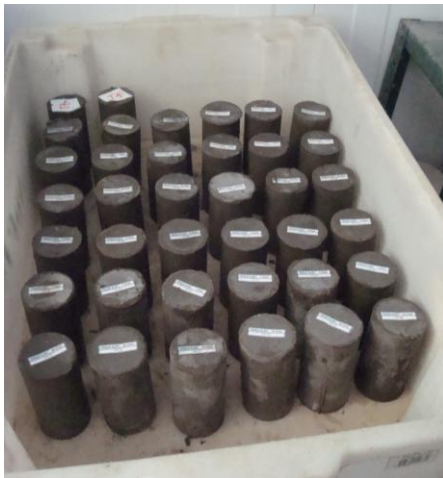
Figura 10 – Corpos de prova em cura úmida
