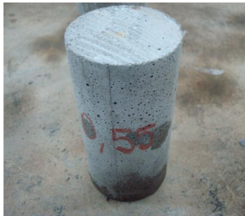
Figura 13 – Base do corpo de prova retificado
