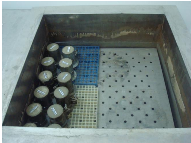
Figura 11 – Corpos de prova em cura térmica
