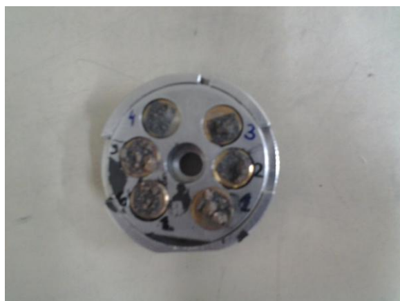
Figura 17 – Amostras metalizadas com ouro
