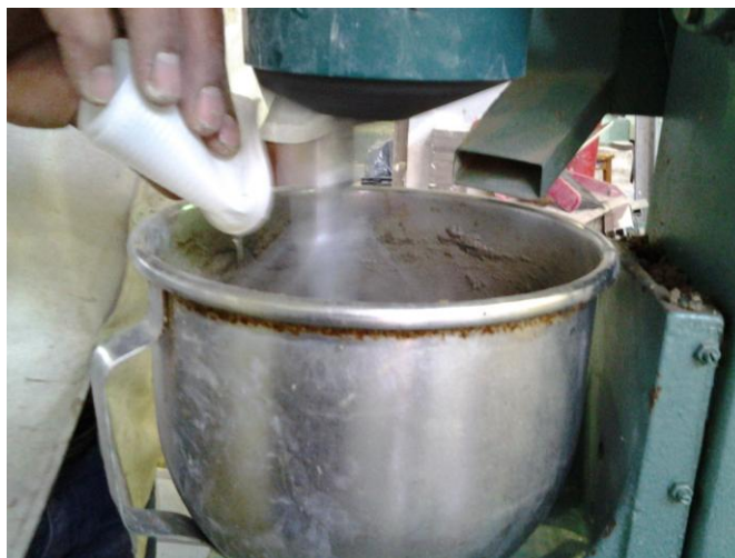
Figura 9 – Aditivo superplastificante adicionado na mistura no período de velocidade alta
