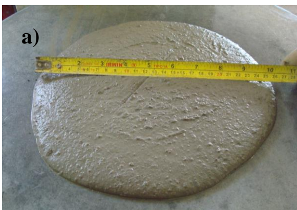
Figura 5 – Consistência da argamassa a) traço 1 – 2ª medida = 260 mm b) traço 3 – 3ª medida = 270 mm
