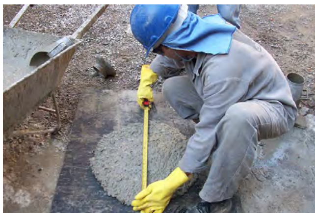
Figura 14 – Ensaio de espalhamento
