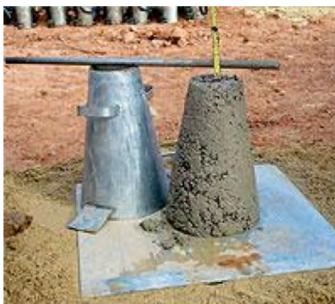
Figura 13 – Realização do slump test
