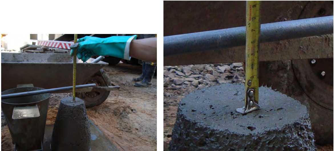
Figura 38 – Abatimento do tronco de cone
