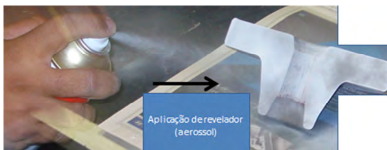
Figura 3.22 – Aplicação de revelador em superfície de interesse.
