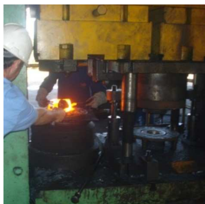
Figura 3.12 – Medição de temperatura no processo com a utilização de um pirômetro manual.
