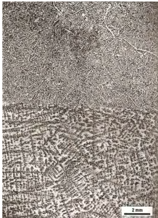
Figura 2.39 – Aço com 0,25% de carbono com ataque de dois reagentes diferentes para revelação de tipos de ferritas e estrutura de solidificação [20].
