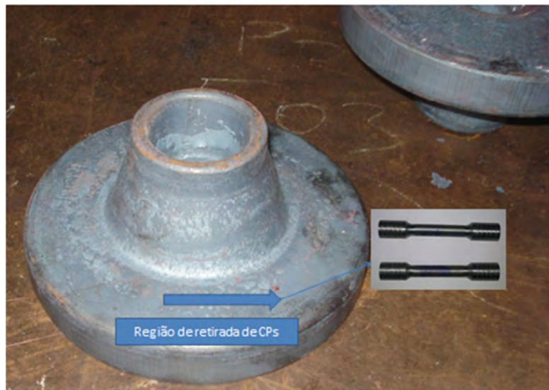
Figura 3.28 – Local para retirada de CP para ensaio de tração.
