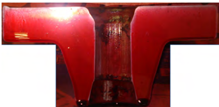
Figura 3.21 – LP aplicado em flanges cortados e retificados.
