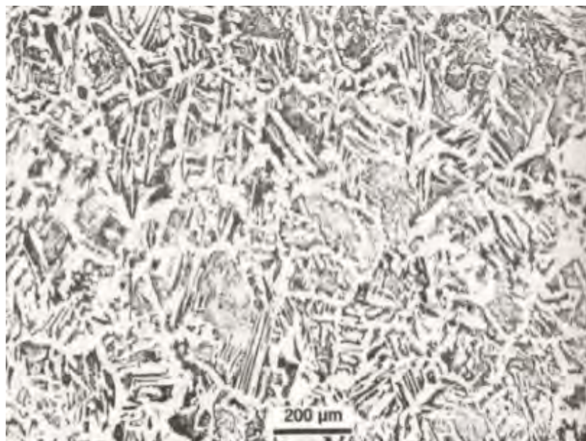
Figura 2.38 – Distribuição de ferrita alotrimórfica nos contornos de grãos anteriores e ferrita Widmanstätten em placas primárias e secundárias (ataque: nital) [20].
