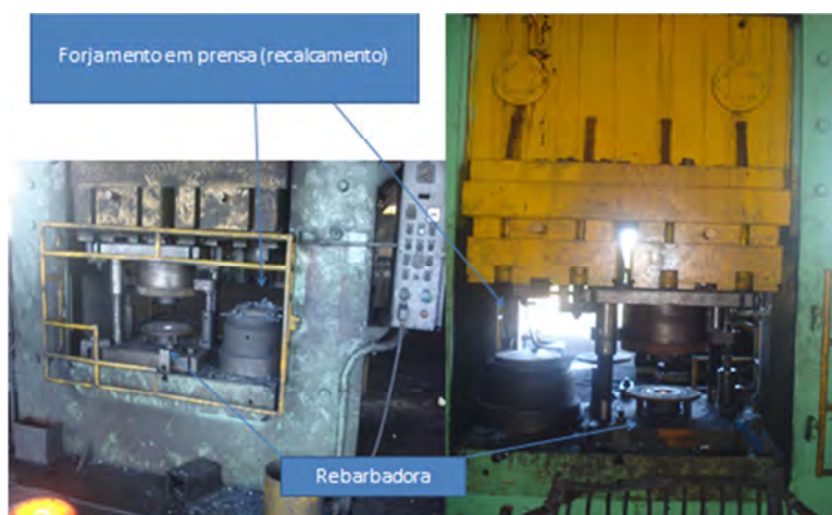
Figura 3.11 – Prensa excêntrica para recalcamento e rebarbamento.
