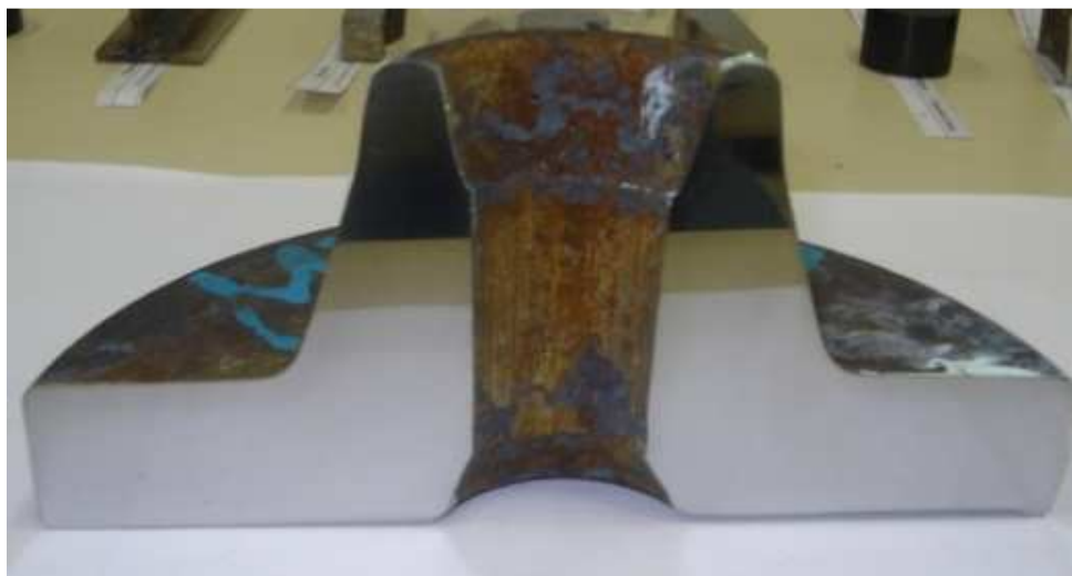
Figura 3.20 – Peça retificada com espelhamento de face conveniente para ataque macrográfico.
