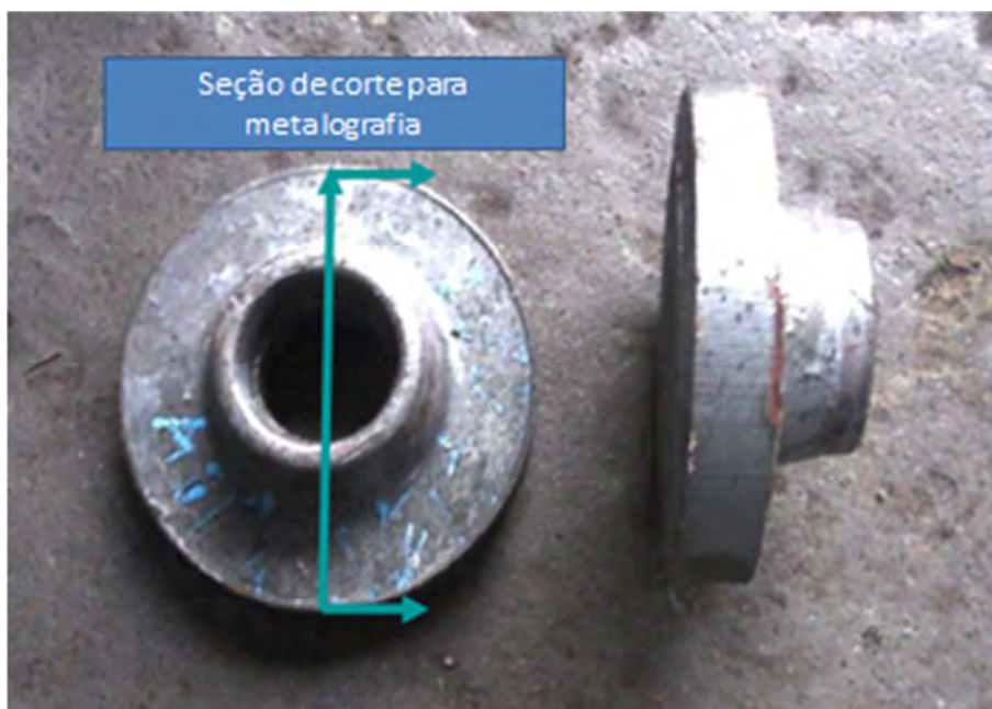
Figura 3.18 – Flange com demonstração de local de corte para metalografia.
