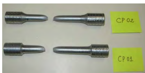
Figura 5.46 – CPs de tração de aço forjado proveniente do LC com AE (fratura dúctil).
