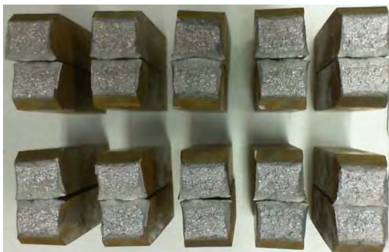
Figura 5.45 – CPs após ensaio de impacto do flange forjado provenientes do LC com AE.
