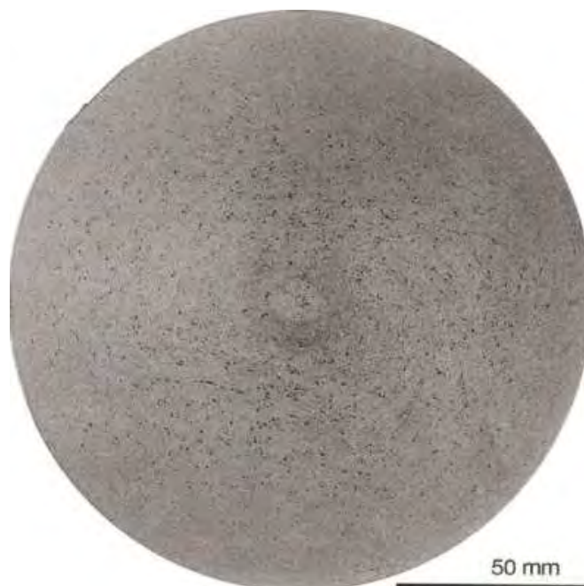
Figura 2.21 – Eixo ferroviário forjado com segregação proveniente do lingotamento com homogeneidade devido a maior deformação (Ataque: ácido clorídrico) [20].
