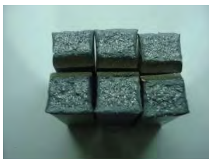
Figura 5.41 – CPs de ensaio de impacto de aços forjados provenientes do LC sem AE somado à LQ sem destaque de descontinuidade.
