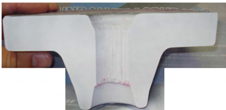
Figura 5.37 – Superfície de aço forjado proveniente do LC com AE sem descontinuidades.
