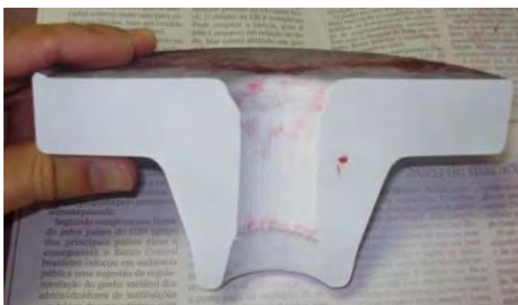
Figura 5.36 – Descontinuidade aparente na superfície de interesse do forjado proveniente do LC sem AE.
