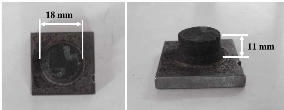
Figura 3.1 - Formato e dimensões principais dos corpos de prova utilizados nos ensaios.
