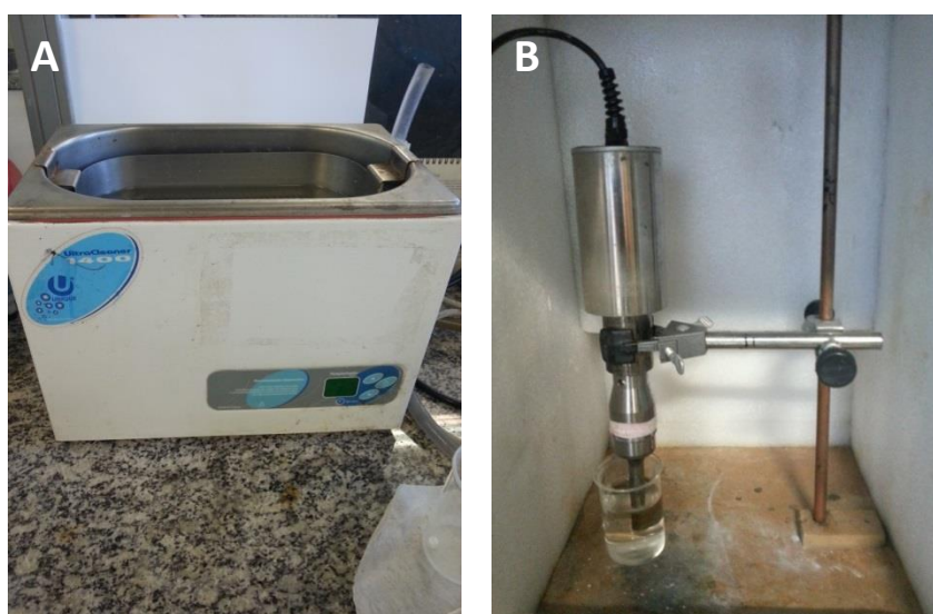
Figura 9: Equipamentos de ultrassom. (A) Tipo banho (Ultracleaner 1500, Unique) e (B) tipo ponteira (Ultrasonic Processor 500W, Cole-Parmer)
