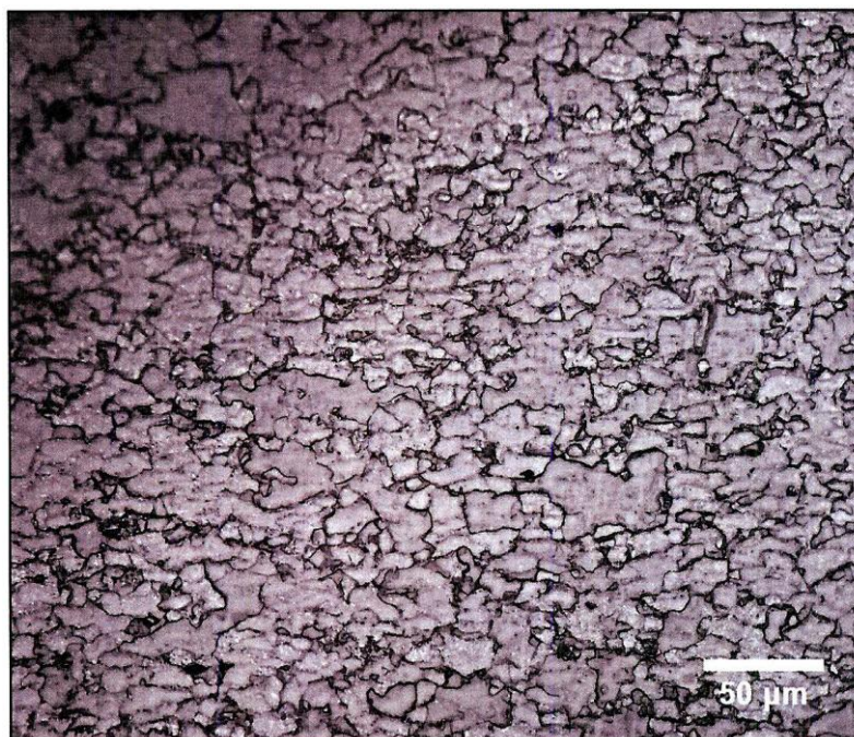
Figura 14: Réplica metalográfica do ponto 22 – Serpentina 33 do SH1, junto à solda de topo. Material SA-213-T91. Ampliação 500X
