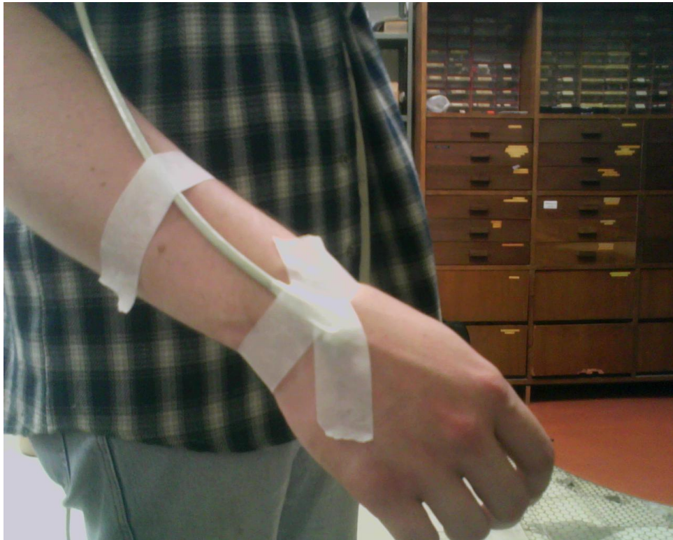
Figura 4.2: Fixação do acelerômetro.
