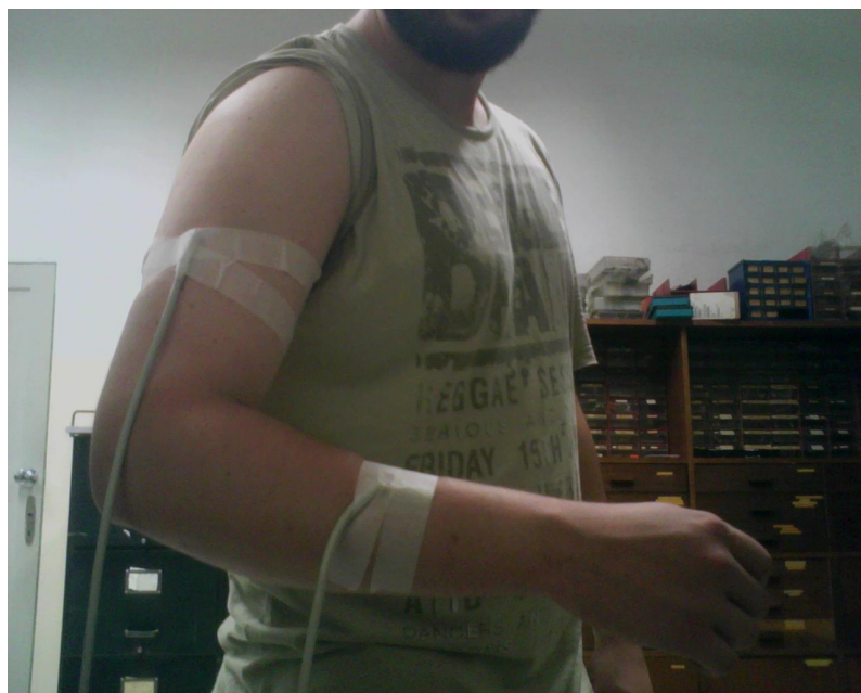
Figura 4.9: Fixação de um par de acelerômetros no voluntário.
