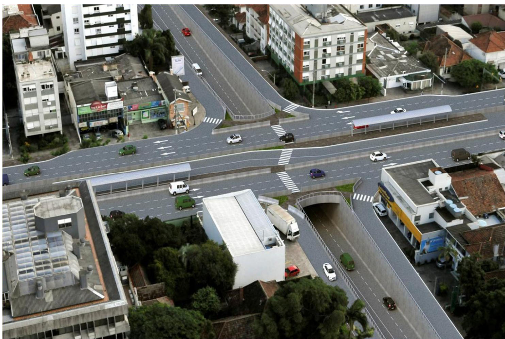
Figura 3 – Vista superior do projeto de trincheira para o cruzamento entre a rua Dom Pedro II e avenida Cristóvão Colombo
