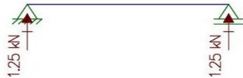
Figura 45 – Reações da sobrecarga da laje LC1
