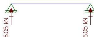
Figura 34 – Reações da laje LC1 nas vigas
