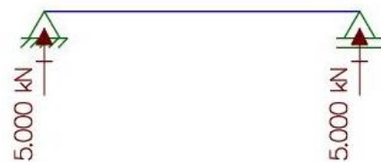
Figura 43 – Reações da sobrecarga da laje L1
