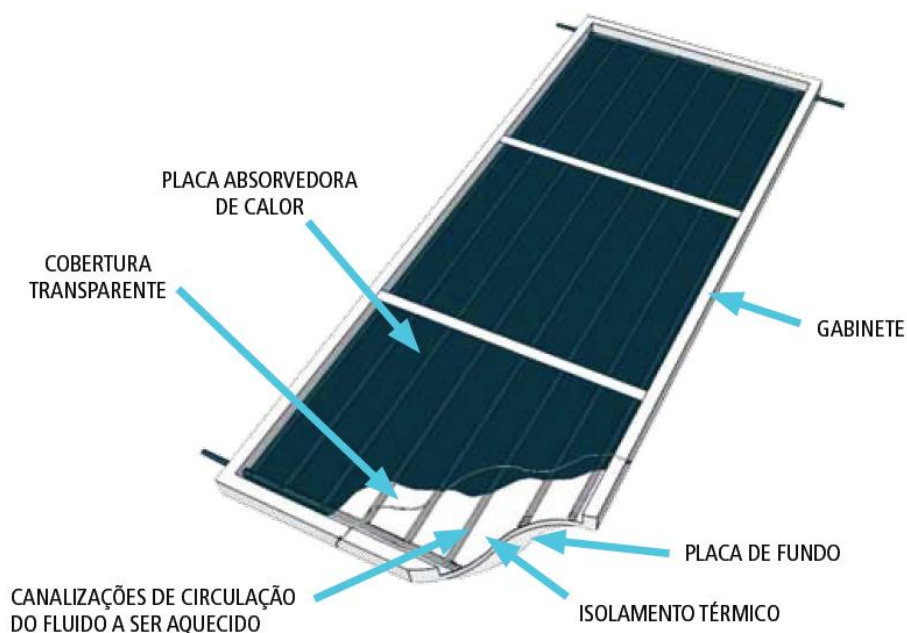
Figura 7 – Coletor solar de placa plana
