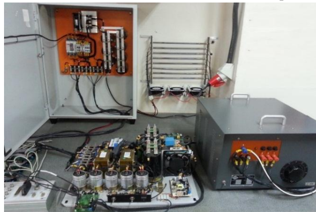
Figura 44 – Inversor comercial de 5kVA utilizado para testes.
