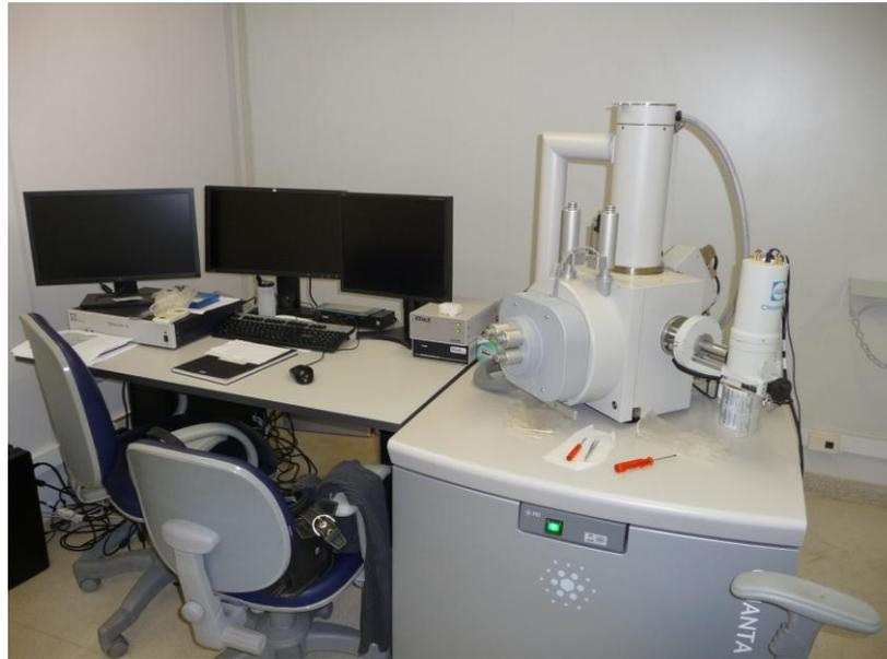
Figura 17 - Microscópio eletrônico de varredura da marca FEI, modelo quanta 450.
