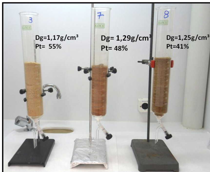
Figura 10 - Colunas com as amostras de solo antes da contaminação. Dg= densidade global; Pt= porosidade total.
