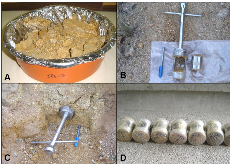
Figura 5 - Ilustração das diferentes etapas para a aquisição das amostras: A) Amostra de solo deformada; B) Amostrador com anéis de bordos cortantes; C) Coleta de amostra indeformada; D) Amostra indeformada.
