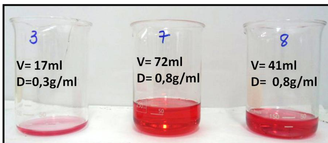
Figura 12 - Estágio final - resíduo do diesel escoado das amostras após o experimento. V= volume; D= densidade. Salienta-se que a densidade inicial do diesel antes do experimento era de 0,8 g/ml.
