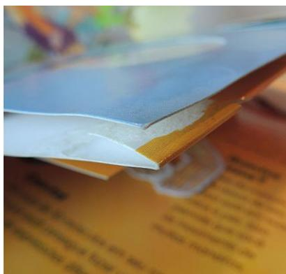
**Figura 28: Folhas coladas à direita com auxílio da aba**
