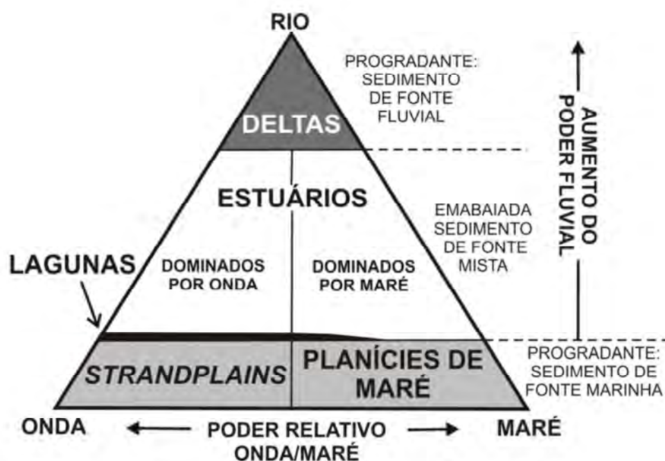
Figura 4. Diagrama ternário de classificação dos sistemas costeiros em função do processo de transporte de sedimentos. Modificado de Boyd et al. , (1992).
