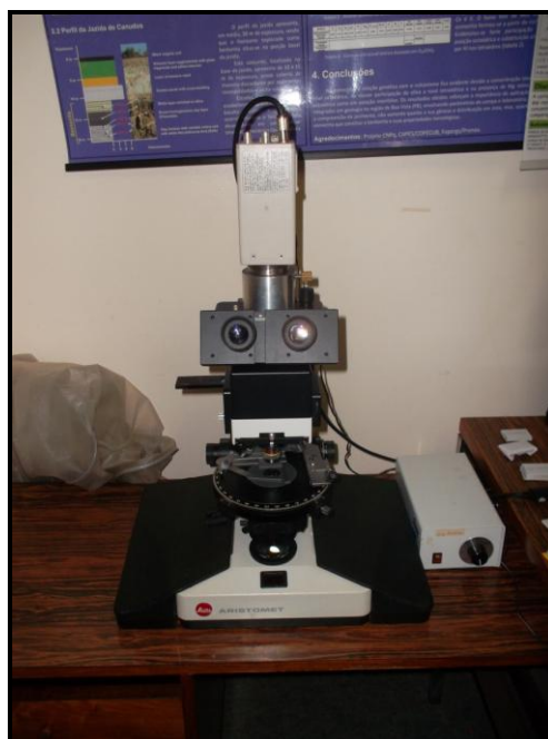
Figura 1 - Microscópio Leitz Wetzlar modelo ARISTOMET – 553428 com câmera acoplada.
