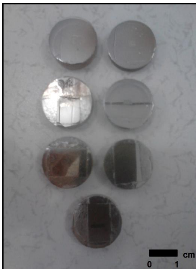
Figura 4 - Pastilhas metalizadas com película de carbono para análise em microsonda eletrônica.
