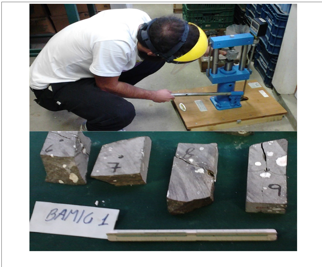
Figura 9: Execução do ensaio de Carga pontual.
