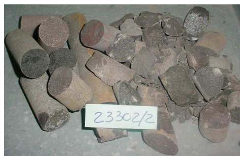
Foto 2 - Aspectos como cor e textura típicos da amostra 23302/2.
