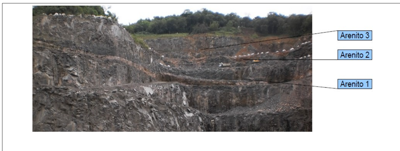
Figura 13: Foto das frentes de lavra da pedreira, detalhe para as lentes de arenito(intertraps).
