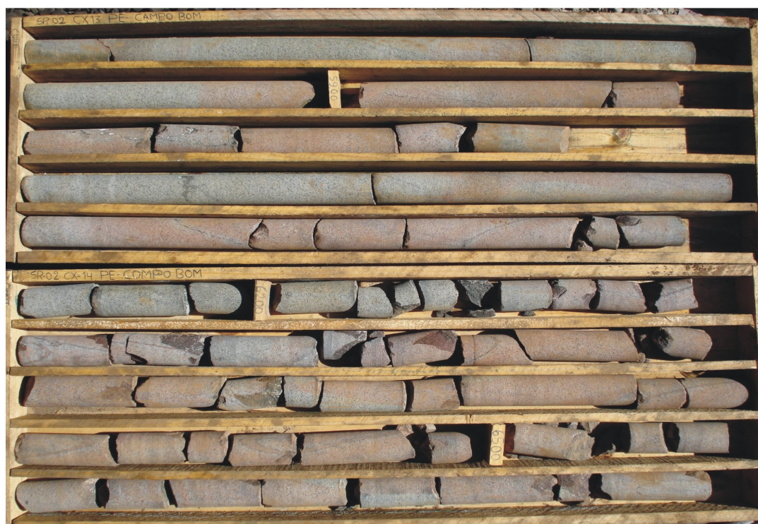
Figura 7: Foto a partir de testemunhos de sondagem extraída de relatório de pedreira.
