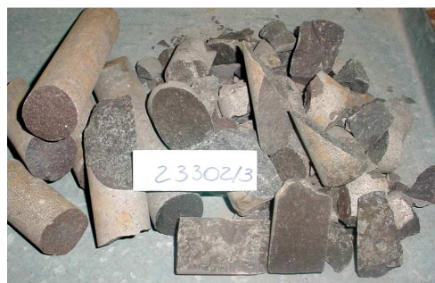
Foto 3 - Aspectos como cor, textura e fraturas naturais típicos da amostra 23302/3.
