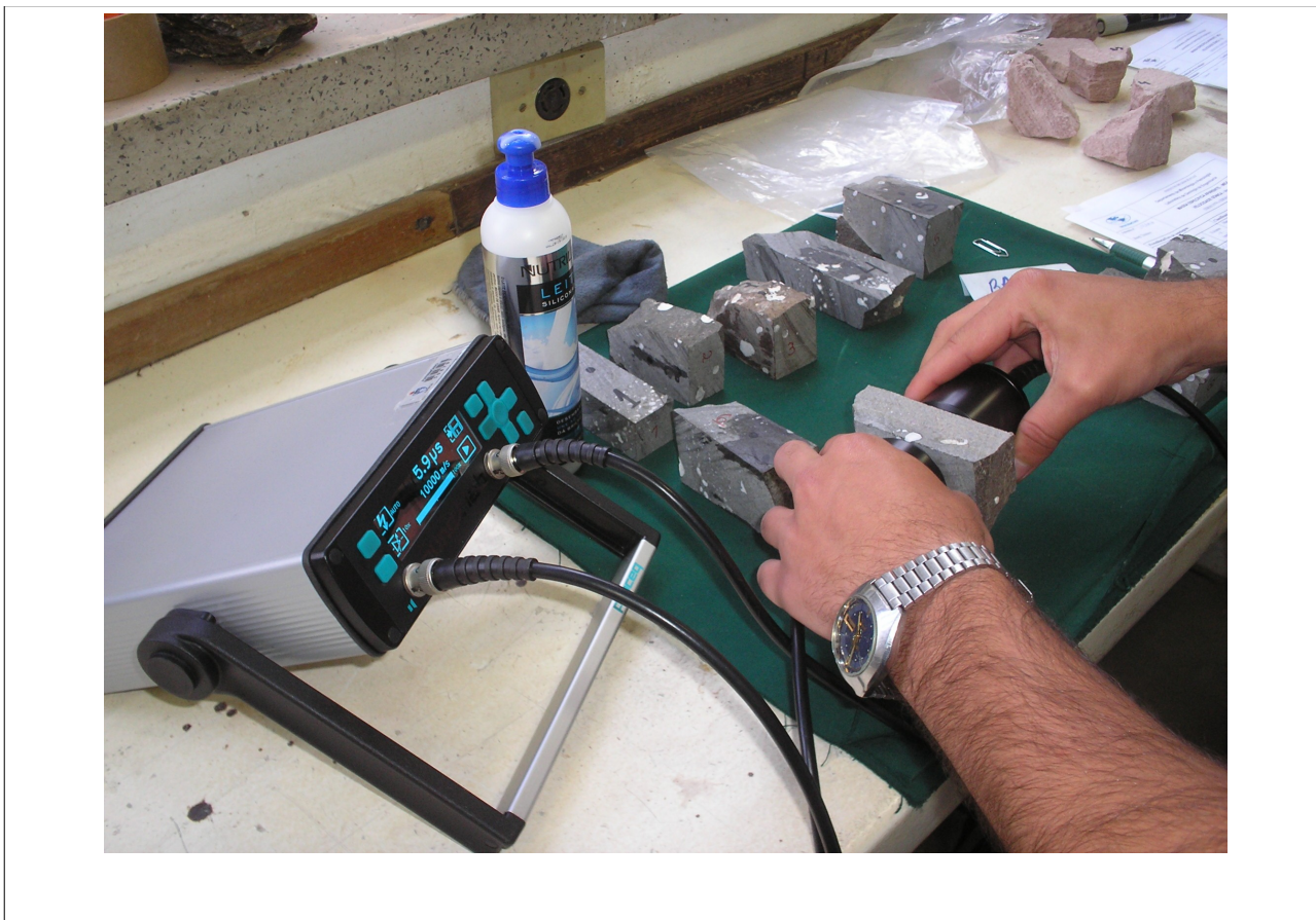
Figura 10: Determinação da Velocidade de propagação de ondas sônicas em amostra de basalto amigdalóide.
