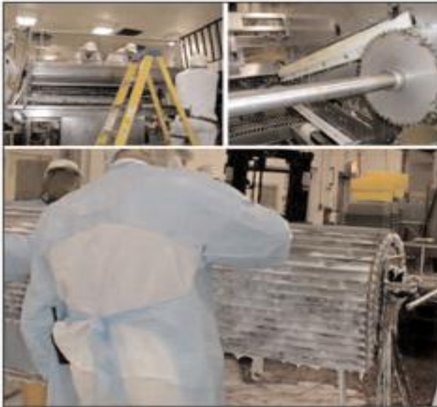
Figura 2 – Remoção de rodas dentadas internas de um equipamento durante uma operação COP e colocação de uma corrente transportadora em um tanque de COP.
