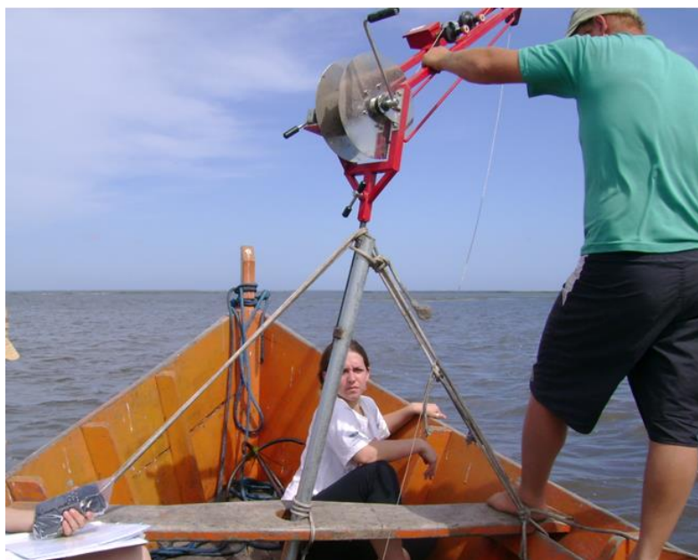
Figura 30: Coleta das amostras de sedimento com o amostrador.
