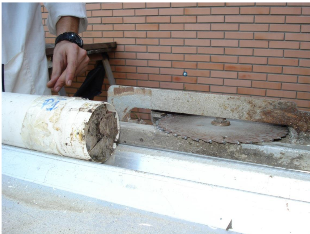
Figura 39: Processo de corte do cano de PVC.
