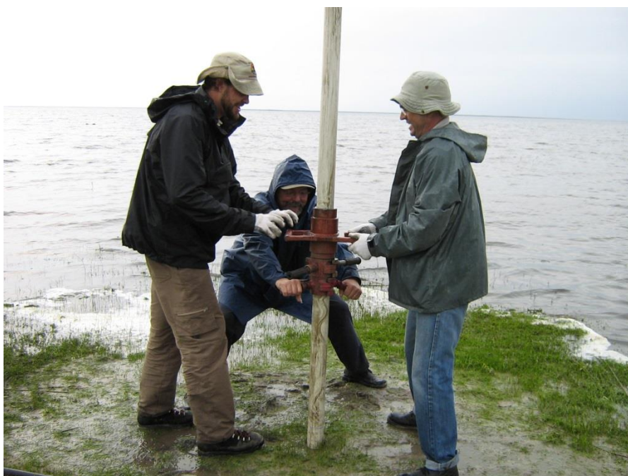
Figura 36: Execução de testemunhagem à percussão com tubo de PVC na superfície da planície deltáica.
