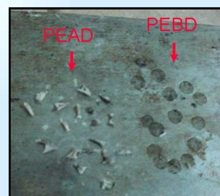
Figura 5. Diferenças de formas da solidificação do PEAD e PEBD após queima.
