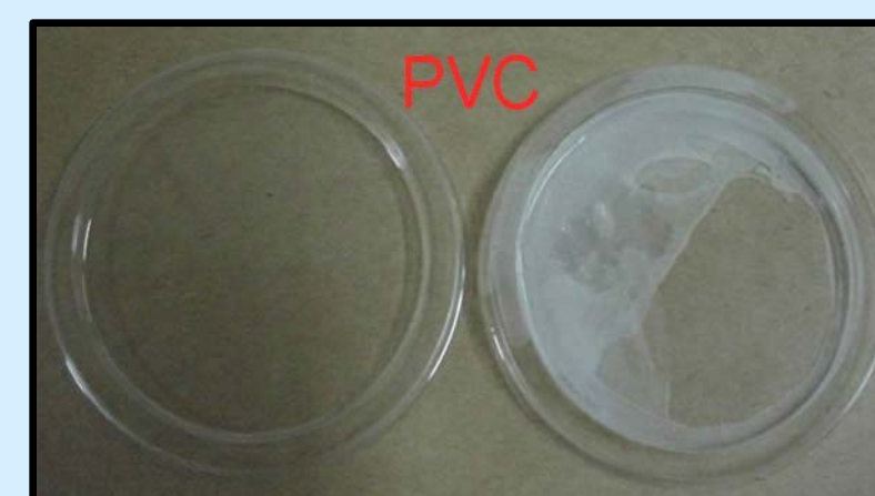
Figura 4. Teste mostrando a reação de PVC ao uso de acetona.
