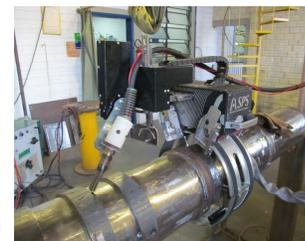
Figura 06 – Sistema Tártilope V4<sup>®</sup> de soldagem orbital.
