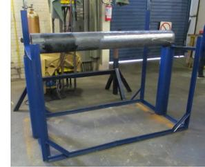
Figura 04-05 – Abertura da calha e posicionamento para soldagem
