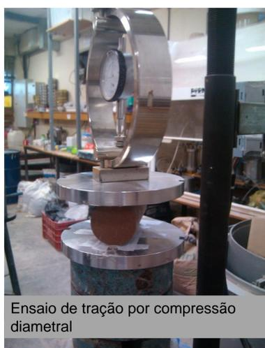
Ensaio de tração por compressão diametral
