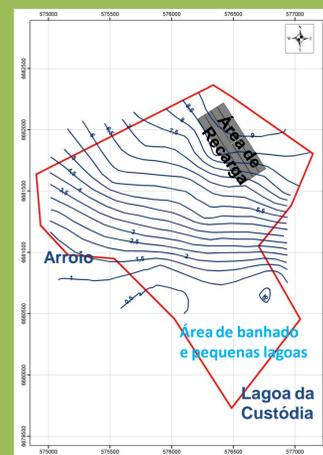
Fig 01: Curvas Isopotenciométrica do aquífero na área de estudo, definida no modelo conceitual. O Polígono vermelho representa os limites da área do modelo matemático de fluxo.
