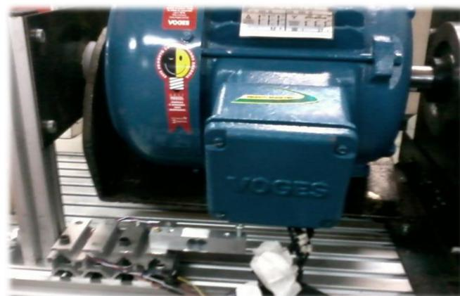
Figura(2) – Detalhe do motor em balanço com célula de carga acoplada
