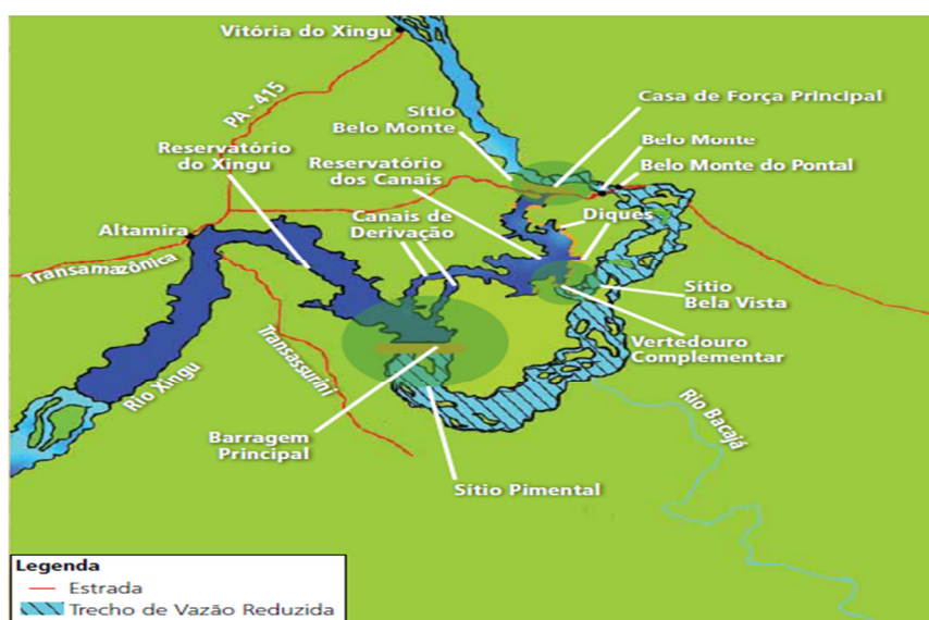
Figura 35: Esquema demonstrando principais locais de obra e elementos constituintes da construção da hidrelétrica de Belo Monte.
