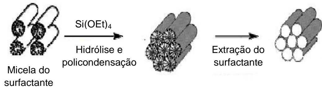
Figura 10 – Formação de materiais utilizando como molde um surfactante.
