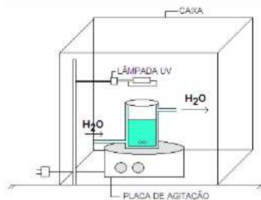
Figura 12 – Esquema do sistema para os testes catalíticos.
