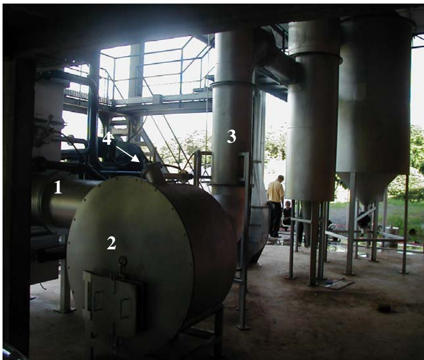
Figura 17: Vista do reator de oxidação (1.zona secundária de combustão; 2.zona terciária de combustão; 3.zona quaternária de combustão; 4.queimador)
