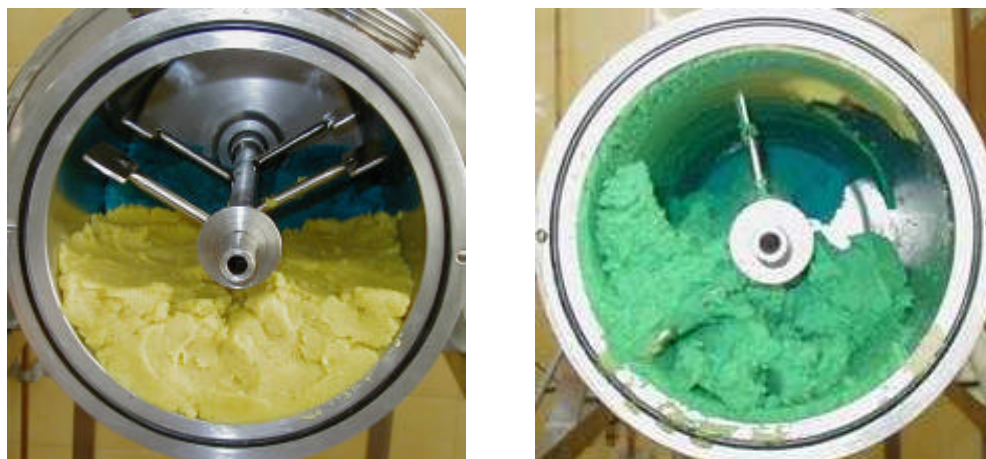
Figura 4.4: Aspecto do biorreator ao início e após 45 minutos no teste de mistura axial.
