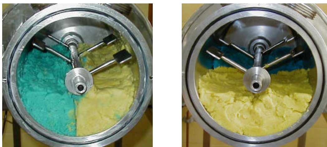
Figura 3.2: Disposição inicial da fibra nos testes de mistura. Esquerda: teste de mistura radial; Direita: teste de mistura axial.
