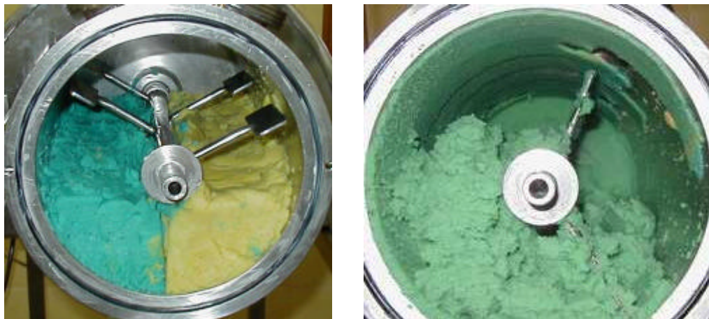
Figura 4.3: Aspecto do biorreator ao início e após 15 minutos no teste de mistura radial.
