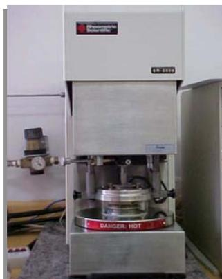
Figura 17 – Fotografia do reômetro rotacional SR 5000
