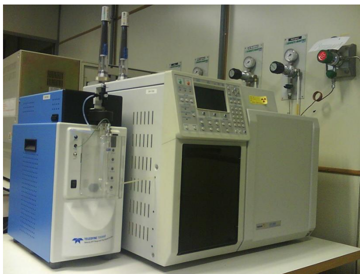
Figura 5. Cromatógrafo gasoso com detector por captura de elétrons (GC-ECD), Varian CP-3800. Foto: Karine O. Garcia, 2009.
