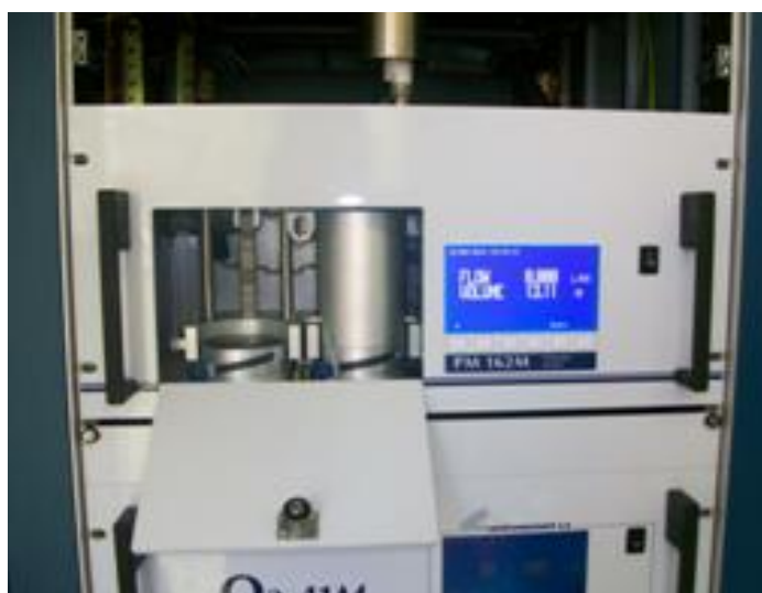
Figura 3. Amostrador automático de material particulado (PM162M), Environnement S.A. Foto: Dayana Agudelo-Castañeda, 2011).
