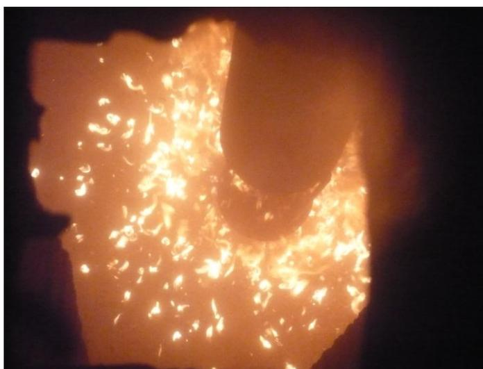
Figura 47: Comportamento da casca de arroz no leito fluidizado borbulhante.
