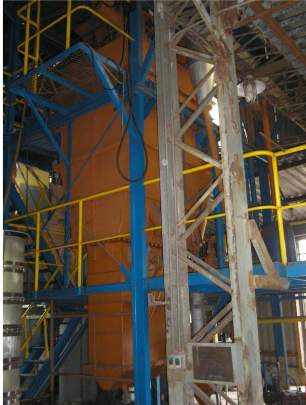
Figura 35: Carcaça do reator em leito fluidizado borbulhante de 0,25 MW<sub>th</sub>.
