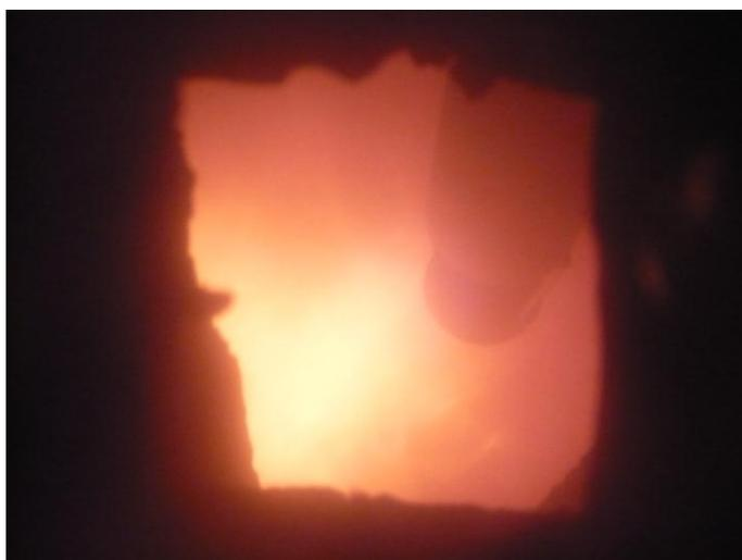
Figura 45: Comportamento da combustão do carvão no leito fluidizado borbulhante.
