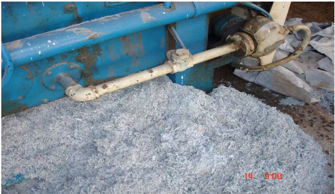
Figura 5.3: Pó e raspa da rebaixadeira de couro bovino.
