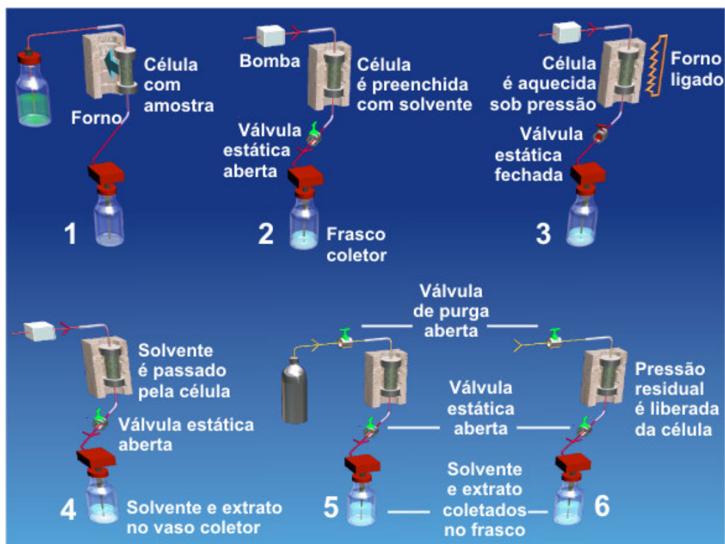
Figura 3: Etapas de extração com líquido pressurizado no sistema ASE300® – Dionex
