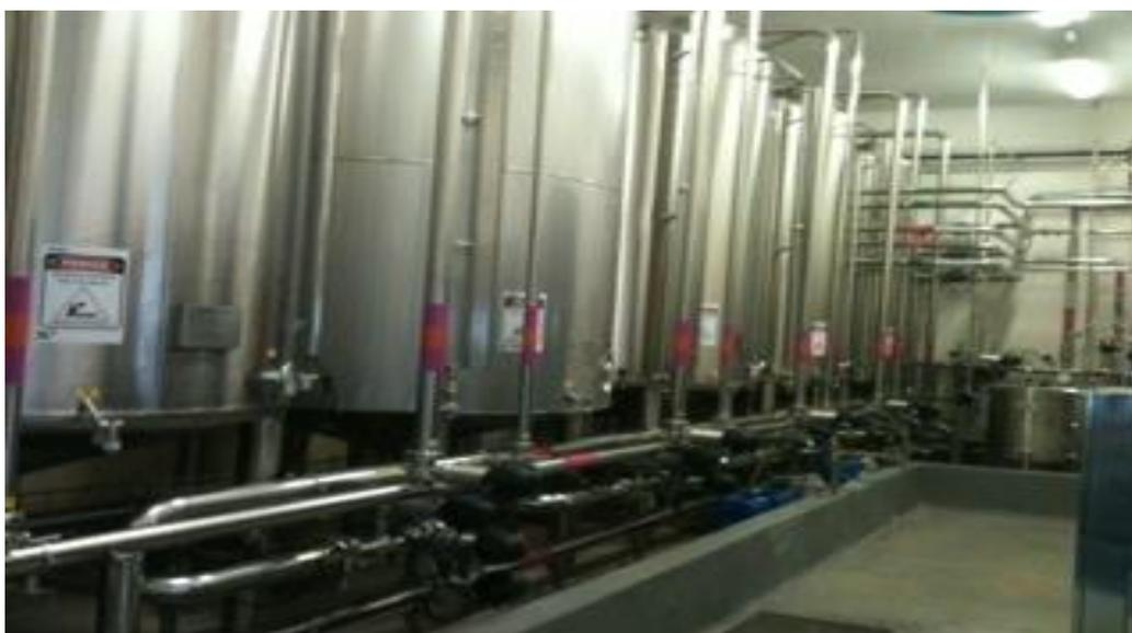
Figura 10: Estação CIP com 5 Tanques
