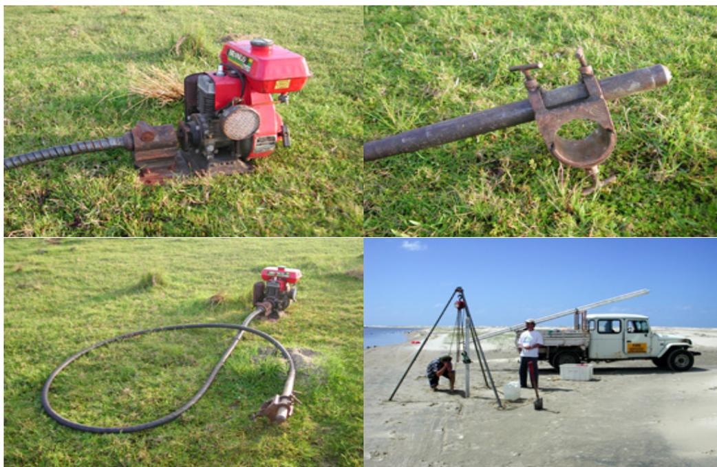
Fig.19. Principais componentes do sistema de testemunhagem a vibração (Motor, Mangote, Braçadeira, Ponteira e Tripé).
